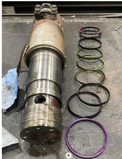
Les défaillances des joints se manifestent par une fuite d'huile externe, qui peut être identifiée à tort comme une défaillance du joint du carter du moteur ou une fonction de cisaillement compromise, comme une faible puissance, une difficulté à ouvrir la mâchoire ou une dérive régulière de la mâchoire. Ces problèmes peuvent généralement être résolus à l'aide de jauges hydrauliques ou d'un test de dérivation du collecteur.
