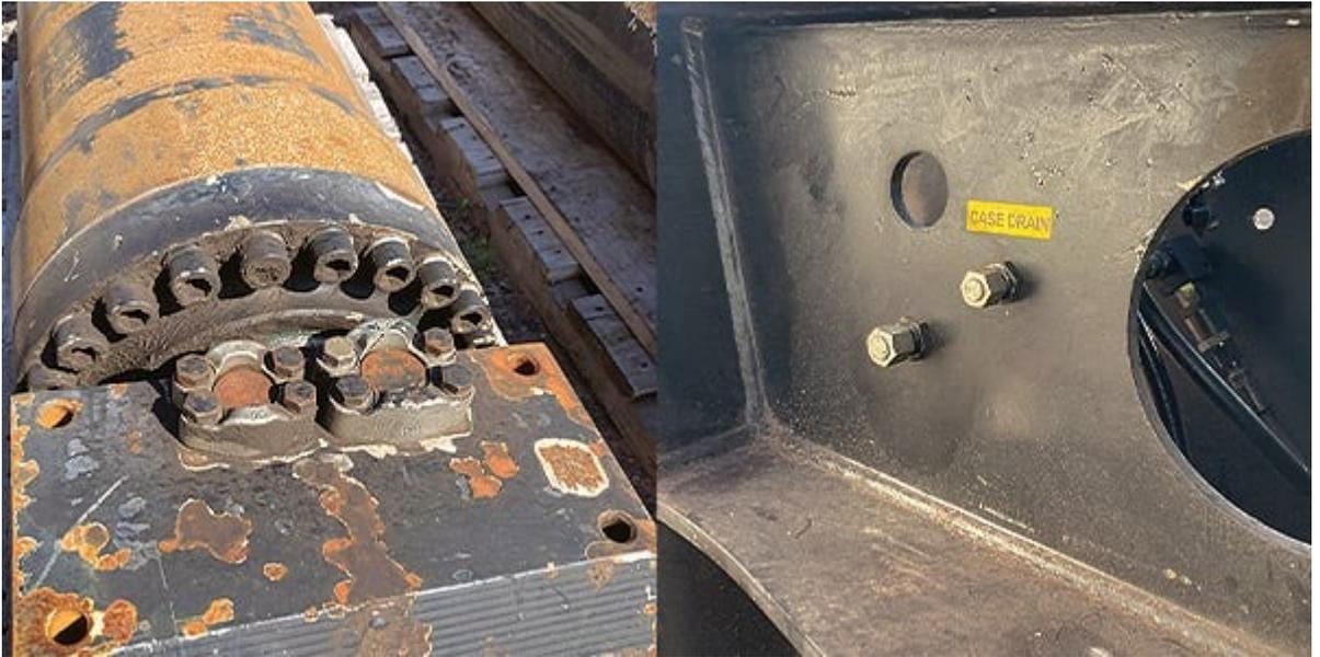
También se pueden arruinar los cilindros y los componentes giratorios y oscilantes si el accesorio no está preparado para su almacenamiento. En los climas cálidos, el aceite de los componentes se puede calentar, expandir y hacer presión hacia afuera, lo que contaminaría todo a su alrededor. De este modo, no solo se pueden arruinar los componentes costosos, sino que también el portador de base se contamina y daña.
