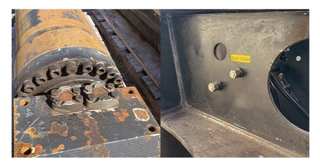
Les vérins, les pivots et les composants de rotation peuvent également être endommagés si l'outil n'est pas préparé pour le stockage. Par temps chaud, l'huile contenue dans les composants se réchauffe, se dilate et s'échappe, contaminant tout ce qui l'entoure. Non seulement les composants coûteux peuvent donc être endommagés, mais l'engin porteur est également contaminé et endommagé.
