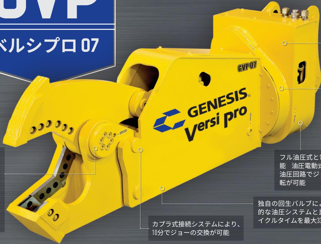
革新的なブラケットシステムにより、スキッドステアのクイックプレートやミニショベルのラグプレートを10分で交換可能
