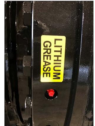
La graisse au lithium Genesis GLG-2(MC) anti-usure pour pression extrême (référence 6302601) est recommandée pour toutes les conditions de température.
