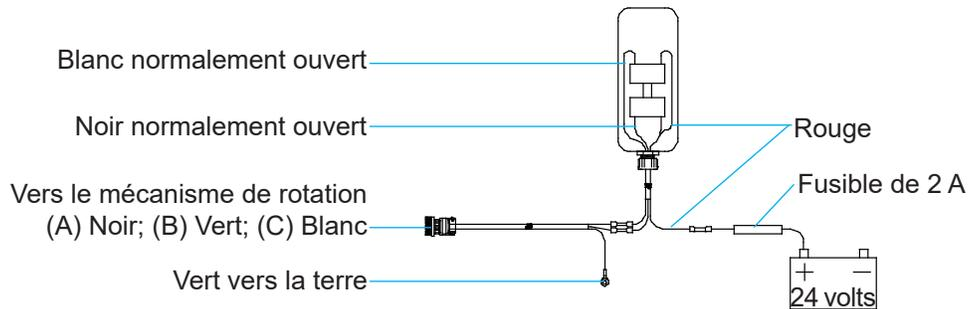
Le mécanisme de rotation nécessite un circuit hydraulique supplémentaire. L'une des nombreuses options disponibles a été fournie avec l'accessoire. Ces schémas illustrent l'installation du circuit supplémentaire. Reportez-vous à la section Entretien du système hydraulique/mécanisme de rotation de ce manuel pour consulter la description, les fonctions et les réglages des vannes.
