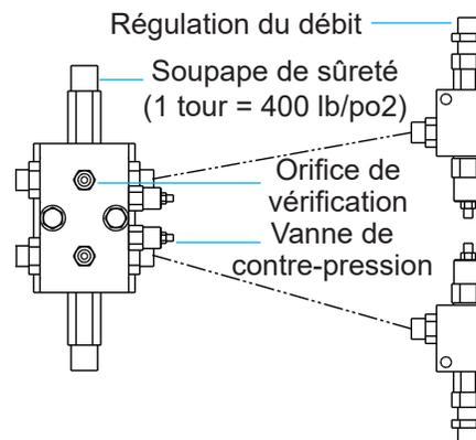
Si vous ne pouvez pas atteindre la pression spécifiée dans le tableau des réglages des vannes de rotation, réglez les vannes de contre-pression en suivant cette procédure :
