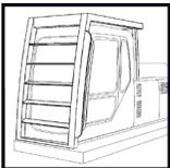
Évitez autant que possible de manipuler des matériaux en hauteur. Des protections de cabine en verre de sécurité et en treillis métallique doivent être installées pour protéger l'opérateur des débris volants qui peuvent être générés pendant la manutention. Les structures de protection contre les chutes d'objets sont nécessaires pour toute utilisation où du matériel doit être manipulé en hauteur.
