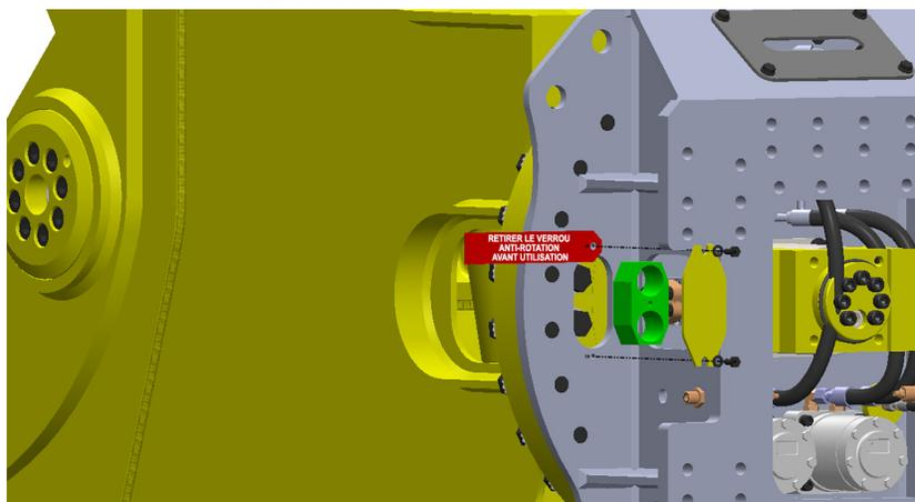
Les verrous anti-rotation se trouvent à l'intérieur des caches des petits boulons de la couronne de rotation et sont marqués d'une étiquette rouge portant la mention « REMOVE ROTATION LOCK BEFORE OPERATION » (RETIRER LE VERROU ANTI-ROTATION AVANT UTILISATION). Le boulon du couvercle peut être retiré en le passant par le verrou anti-rotation.
