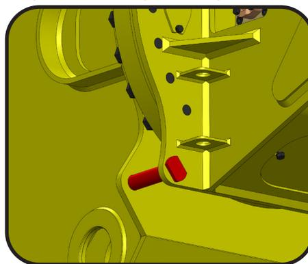
Outils équipés de blocs de verrouillage de la couronne de rotation pour le transport :
