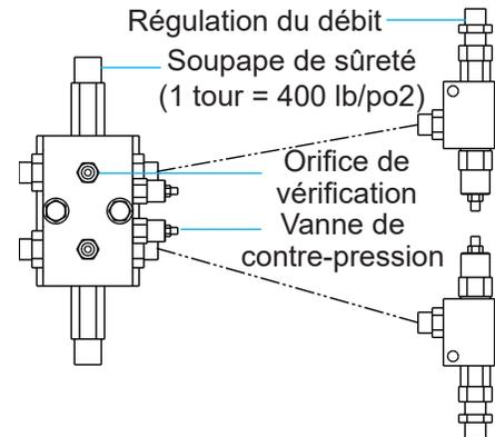
Réglage de la vanne de contre-pression avec une vanne de commande des mouvements : suivez la procédure de la page précédente.
