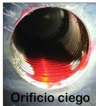
Para las conexiones con boquillas hidráulicas roscadas, aplique Loctite 5452 o un sellador de roscas equivalente en conjunto con el imprimador Loctite 7471 usando el siguiente procedimiento:
